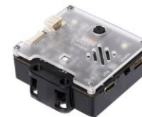
Slimme Pixycam voor kleur en vorm herkenning
