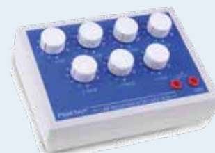
WEERSTAND LAB DECADE BOX MET POTMETER ~ 1 \Omega ... 11,111 M \Omega (105408)
