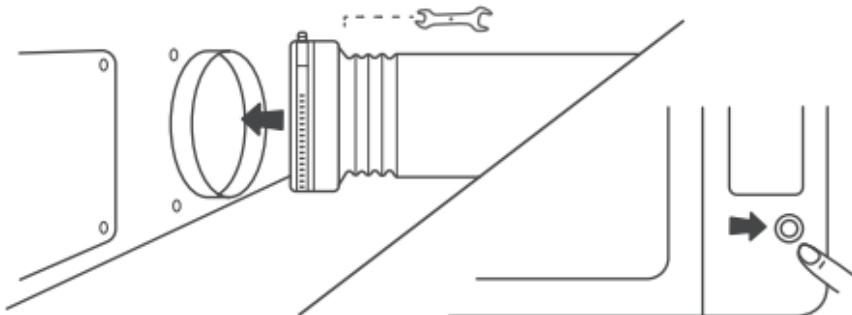
3. Zet de machine aan met de aan/uitknop. De eerste keer kan het opstarten tot twee minuten duren.
