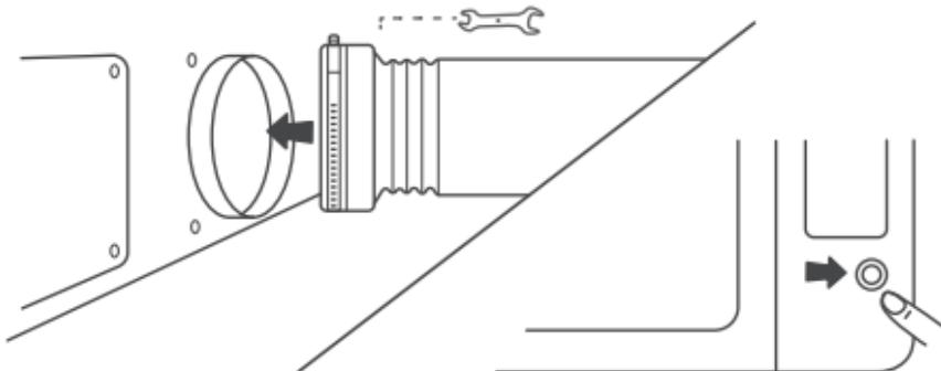
3. Mettez la machine sous tension en appuyant sur le bouton d'alimentation. Le premier démarrage peut prendre jusqu'à deux minutes.
