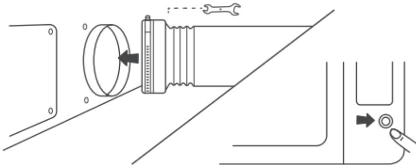
3. Tænd maskinen ved at trykke på tænd/sluk-knappen. Den første opstart kan tage op til to minutter.
