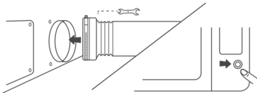
3. Encienda la máquina pulsando el botón de encendido/apagado. La primera puesta en marcha puede tardar hasta dos minutos.
