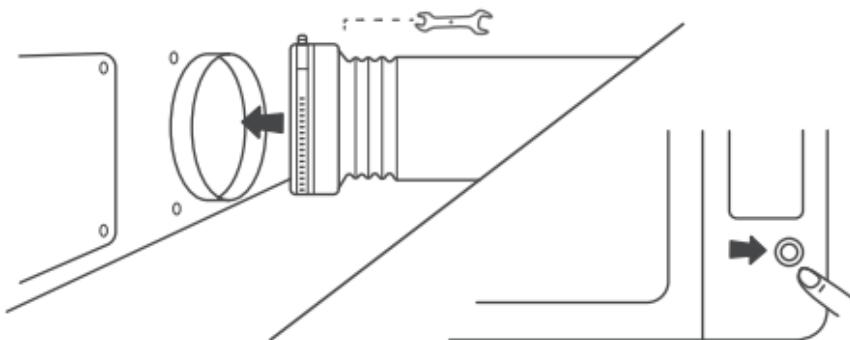
3. Zapněte stroj stisknutím tlačítka napájení. První spuštění může trvat až dvě minuty.
