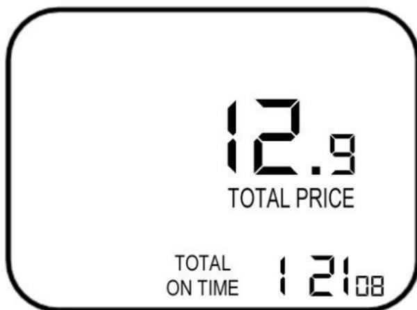
Durch nochmaliges Betätigen der MODE-Taste schalten Sie in den Gesamtpreis Tarif 1- Bereich. Um einen Messwert zu errechnen müssen Sie einen Tarif 1 festgelegt haben. In dieser Anzeige werden die Gesamtkosten für den Tarif 1 angezeigt. Je nach getätigter Einstellung können Sie diesen Wert als Euro-Wert ablesen. Zusätzlich wird die Einschaltzeit während des Tarifes angezeigt.
