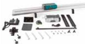
Dieses Fahrbahn-Komplettset enthält eine 1,2 m lange Fahrbahn, zwei reibungsarm gelagerten Kunststoffwagen und Zubehör.
