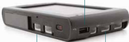
Zwei digitale Sensoranschlüsse für Bewegungsdetektor, Lichtschranken, Tropfenzähler und mehr.
