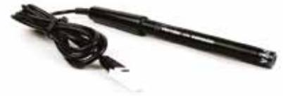
Wir bieten zwei verschiedene Sensoren zum Messen der Intensität von UV-Strahlung an. Einer reagiert hauptsächlich auf die UVA-Strahlung (320 - 375 nm), der andere reagiert vor allem auf die UVB-Strahlung (290 - 320 nm). UVB wird normalerweise mit Sonnenbrand, grauem Star und Hautkrebs in Verbindung gebracht, während UVA für vorzeitiges Altern der Haut und einige Typen von Hautkrebs verantwortlich ist. Welchen Sensor Sie verwenden, hängt von Ihrem Versuch ab.
