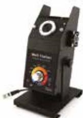
Die neue Schmelzstation ermöglicht in Verbindung mit Vernier Computerinterfaces die Messung der Schmelztemperatur fester Substanzen.
