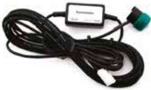
Das Vernier-Pyranometer erfasst die elektromagnetische Strahlung in Watt pro Quadratmeter ( $W/m^2$ ). Es reagiert auf nahe Infrarot-, sichtbare und UV-Strahlung. Hier ist die meiste Sonnenenergie konzentriert. Es eignet sich hervorragend zu Versuchen mit Solarzellen und deren Effizienz. Der Sensor ist wetterfest und hat eine kuppelförmige Abdeckung. Diese erlaubt eine Erfassung in einem weiten Einstrahlwinkel. Das Pyranometer hat ein 6 m langes Anschlusskabel.
