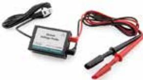
Dieser Sensor wird zum Messen von Spannungen im Bereich von  $-30$  bis  $+30$  V eingesetzt. Der Einsatz des Sensors wird notwendig bei allen Experimenten mit Spannungen über  $10$  V, z.B. beim Arbeiten mit großen Solarpanels. Da der Sensor einen großen Bereich überstreicht, ist die Auflösung niedriger als beim differentiellen Spannungssensor.
