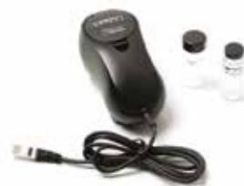
Der Trübungssensor wird zur Messung der Trübung von Süß- oder Salzwasserproben verwendet. Der Wert wird in NTU (Nephelometric Turbidity Unit), identisch mit FTU (Formazine Turbidity Unit) angegeben.
