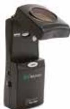
Go!Motion besitzt die gleichen Eigenschaften wie der Bewegungsdetektor, wird jedoch direkt am Computer oder LabQuest mit USB angeschlossen.
