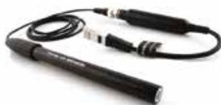
Dieser neue, spezielle pH-Sensor ist kompatibel mit TRIS-Puffer und proteinhaltigen Lösungen. Durch die flache Kontur ist er ideal für die pH-Messung von halbfesten Stoffen, wie z.B. Lebensmitteln oder Erdböden.
