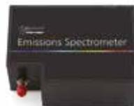
Das perfekte Werkzeug für Emissionsanalysen. Das Vernier Emissions-Spektrometer erfasst Emissionsspektren von Glühlampen, Gasentladungsröhren oder der Sonne. Es wird an den Computer oder an das LabQuest mit einem Standard-USB-Kabel angeschlossen und erlaubt präzise Messungen im Bereich von 350 bis 900 nm. Das Spektrometer arbeitet mit oder ohne Lichtleiter.
