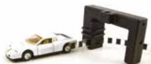
Dieser Satz enthält ein Gitterband und eine Führung zur Verwendung mit der Lichtschanke. Das Band kann an Objekten befestigt und durch die Lichtschanke gezogen werden. Ideal für Experimente die mit einem Lochstreifenzeitmesser durchgeführt werden.
