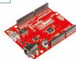
Das SparkFun Red Board ist ein Arduino-kompatibles Board mit SMD-Bestückung. Die USB-Buchse ist ein Mini-USB-Typ B. Die Stromversorgung erfolgt entweder über die USB-Buchse oder über die Niederspannungsbuchse (7-15 V). Ein USB-Kabel wird mitgeliefert.
