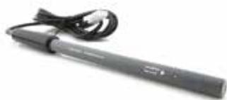
Die Ionenselektiven Elektroden (ISE) werden zur Überwachung von fünf umweltrelevanten Ionen eingesetzt: Nitrat (NO<sub>3</sub>-), Chlorid (Cl-), Kalzium (Ca<sup>2+</sup>), Ammonium (NH<sub>4</sub><sup>+</sup>) und Kalium (K<sup>+</sup>).
