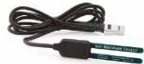
Der Bodenfeuchtesensor misst den Wassergehalt im Boden nach einem kapazitiven Verfahren. Er wird einfach in den zu testenden Boden gesteckt und der Wassergehalt wird in Volumen-Prozent übermittelt. Er wird bei Versuchen der Umweltwissenschaft, im Gartenbau, in der Agrarwissenschaft, Biologie usw. verwendet.
