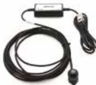
Der PAR- (Photosynthetically Active Radiation) Sensor misst die photosynthetisch wirksame Strahlung in Luft und Wasser. Der wasserdichte Sensor erfasst Strahlung aus Sonnenlicht und künstlichen Lichtquellen. Der Spektralbereich ist ausgelegt auf den Bereich, der von Pflanzen für die Photosynthese verwendet wird (400 - 700 nm).
