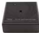
Das Vernier VSP-UV Spektrophotometer ist ein portables Spektrophotometer für den UV und sichtbaren Bereich des Lichts. Es ist einfach zu bedienen und liefert genaue Messungen der Absorptionsspektren von verschiedenen bio-chemischen Verbindungen. Es kann ebenfalls für die Messungen der Reinheit von DNA und Proteinen eingesetzt werden. Als USB-Gerät wird es direkt am Computer oder LabQuest angeschlossen.
