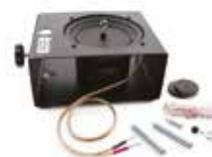
Das Set enthält einen elektrodynamischen Schwingungserreger. Er besteht aus einem Lautsprecher auf dessen Kalotte ein Aufnehmer für Federn usw. befestigt ist.
