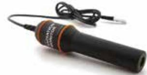
Der Vernier Strahlungsmonitor besteht aus einem Geiger-Müller-Zählrohr in einem robusten, kleinen Kunststoffgehäuse. Er benötigt keine Batterie, da er seine Energie aus dem angeschlossenen Interface bezieht. Er reagiert auf Alpha-, Beta- und Gammastrahlung. Das Zählrohrfenster ist mit einer Metallabdeckung geschützt. Er kann gut verwendet werden zur Erforschung von Strahlung, zur Messung der Rate des radioaktiven Zerfalls oder zur Überwachung von Radonfreisetzungen.
