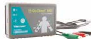
Der Go Direct EKG-Sensor misst elektrische Aktivität im Herzen und elektrische Signale, die bei Muskelkontraktionen entstehen. Die drahtlose Datenübertragung verhindert störende Kabel während des Versuchs. Dieser Sensor bietet zwei separate Ausgänge: einen für Standard-EKG-Aufzeichnungen mit drei Elektroden und einen für Oberflächen-EMG-Aufzeichnungen. EMG-Aufzeichnungen können auch automatisch vom Sensor korrigiert werden.
