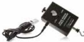
Der Zweibereich-Kraftsensor kann leicht auf einem Ringständer oder Testwagen befestigt werden und ist damit ein Ersatz für eine Handfederwaage. Er hat zwei Bereiche:  $\pm 10 N$  und  $\pm 50 N$  und eine Auflösung von  $0,01 N$  bzw.  $0,05 N$
