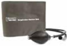
Der Atmungsgürtel wird in Verbindung mit dem Gasdrucksensor (nicht im Lieferumfang enthalten) zur Messung der menschlichen Atmung verwendet. Er wird einfach über die Brust gelegt und mit der Handpumpe mit Luft gefüllt. Anschließend kann man den Druck durch Expansion und Kontraktion der Brust auswerten.
