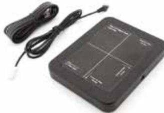
Die Aufprallplatte wird zum präzisen Messen der Flugzeit der Kugel benötigt.
