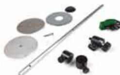
Der Zubehörsatz wird zur Untersuchung eines physikalischen Pendels, der Massenträgheit von Scheiben, Ringen und Punktmassen sowie der Erhaltung des Drehimpulses benötigt.
