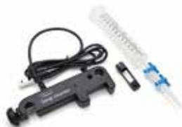
Verwenden Sie den Tropfenzähler mit unserem pH-Sensor, dem Leitfähigkeitsfühler oder REDOX-Potentialsensor zum Durchführen konduktometrischer oder potentiometrischer Titrations.
