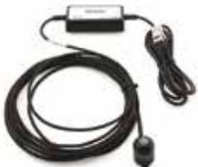
Der PAR- (Photosynthetically Active Radiation, Photosynthetisch wirksame Strahlung) Sensor misst das photosynthetisch wirksame Licht in Luft und Wasser. Er besitzt einen wasserdichten Messkopf. Er spricht auf Licht aus natürlichen und künstlichen Quellen im Bereich von 400 - 700 nm an. Dieser Sensor ist hervorragend geeignet für Untersuchungen von Prozessen rund um die Photosynthese.
