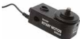
Mit dem Drehbewegungssensor können Sie Winkeländerungen-, Winkelgeschwindigkeits- und Winkelbeschleunigungsdaten präzise und einfach erfassen.
