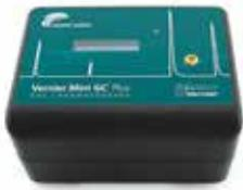
Der Vernier Mini GC Gaschromatograph ermöglicht die Trennung und Identifikation von Verbindungen mittels neuester, patentierter Technologie, die es erlaubt, Luft als Trägergas zu verwenden. Analyse und Spitzenwertintegration kann entweder durch ein LabQuest als eigenständige Einheit oder mit der Logger Pro Software auf einem Computer durchgeführt werden.
