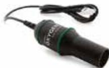
Der O<sub>2</sub>-Gassensor misst die Sauerstoffkonzentration in der Luft. Der große Messbereich erlaubt Studien zur menschlichen Atmung wie zur Zellatmung.
