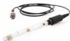
Diese hochwertige pH-Elektrode mit Glaskörper kann in nichtwässrigen Lösungen und Lösungen verwendet werden, die organische Lösungsmittel, starke Säuren oder starke Basen enthalten. Die Elektrode verfügt über eine versiegelte, gefüllte Ag-AgCl-Einstabmesskette und verwendet einen BNC-Anschluss.
