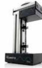
Das chemische Polarimeter wird zur Messung der Rotation von eben-polarisiertem Licht verwendet, das von einer optisch aktiven Substanz hervorgerufen wird. Zum Nachweis der optischen Rotation der Verbindung verwendet das Polarimeter eine 589 nm LED, einen festen sowie einen rotierenden Polarisator. Ein Proberöhrchen gehört zum Lieferumfang.
