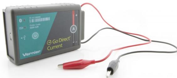
Der Go Direct Stromstärkesensor wurde für das Erforschen der Grundprinzipien der Elektrizität entwickelt. Verwenden Sie den Go Direct Stromstärkesensor zur Messung von Strömen in Niederspannungs AC/DC-Stromkreisen. Mit einem Messbereich von  $\pm 1$  A ist dieser Sensor ideal für den Einsatz in den meisten "Batterie und Glühbirne" Stromkreisen.
