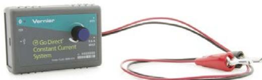
Das Go Direct Konstantstromsystem ist eine Gleichstromquelle mit eingebautem Stromsensor zur Verwendung in elektrochemischen Experimenten. Der Benutzer kann die Stromstärke durch Verwenden des Drehknopfes einstellen. Das System kann bis zu 0,6 A liefern.
