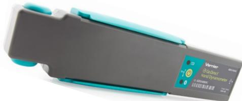
Der Go Direct Handkraftsensor kann zur Messung von Hand- und Fingerkraft und zur Durchführung von Muskelermüdungsstudien verwendet werden. Dieser Sensor wird über die Bluetooth®-Funktechnologie oder USB direkt mit den Schülergeräten verbunden. Die Schüler können Muskelkraft und Ermüdungserscheinungen miteinander in Beziehung setzen, wenn sie einen Go Direct Handkraftsensor und einen Go Direct EKG-Sensor gemeinsam verwenden.
