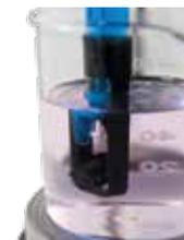
Dieser Magnetrühraufsatz wird einfach auf die pH-Elektrode aufgesteckt. Das Rührfischchen dreht sich, sobald ein Magnetrührer darunter platziert wird. Der Aufsatz ersetzt ein klassisches Rührfischchen. Er ist groß genug, um nicht im Abflusssieb eines Spülbeckens zu verschwinden.
