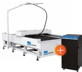
BRM Open Bed + Boven-afzuigstelsysteem + BRM Extractor M
