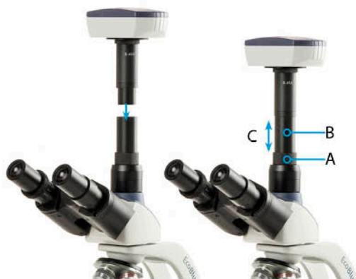
Trinoculaire EcoBlue-kop met camera in fotopoort gemonteerd
